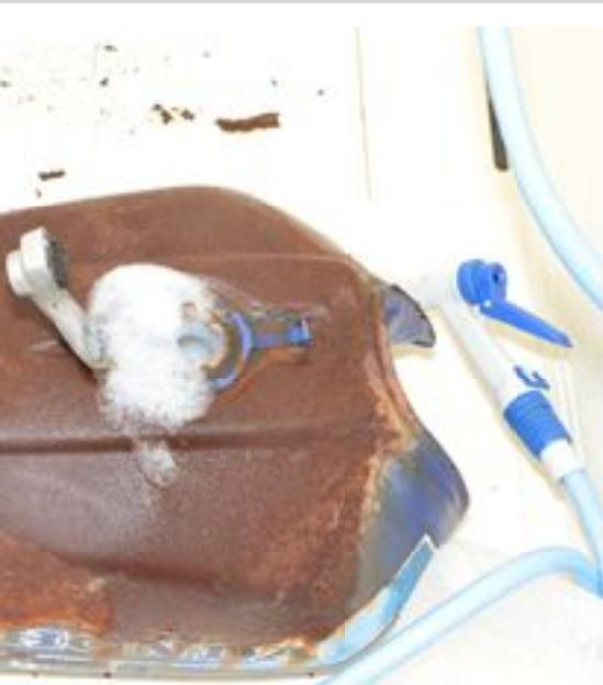
争します。中にガソリンが残っていたりすると、錆び取りがしっかり入念に洗浄します。錆びこの作業を行っていない場合が
